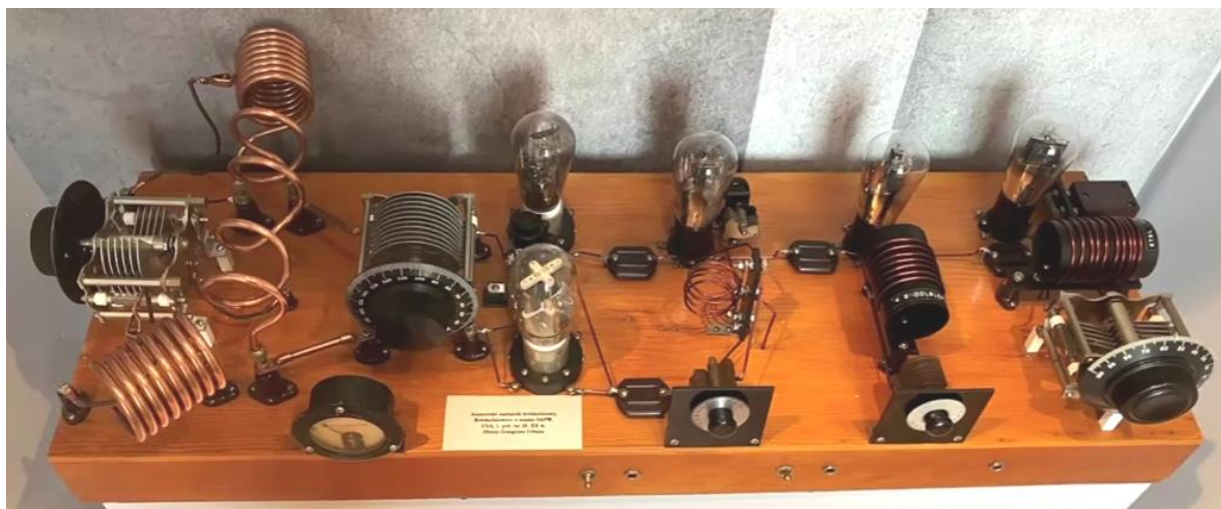
Rys. 2.17.4. Współczesna replika amerykańskiego nadajnika amatorskiego sprzed wieku wykonanego metodą montażu amerykańskiego
